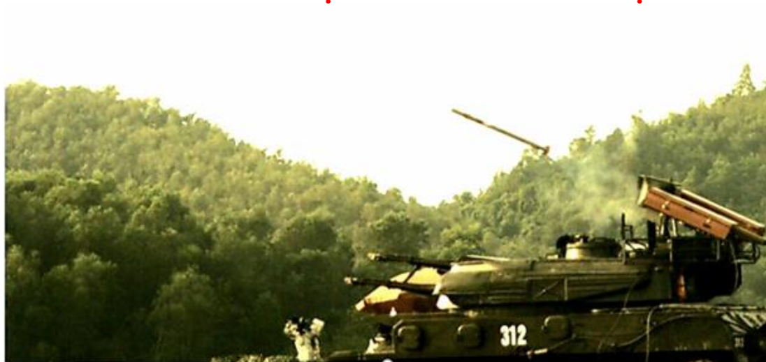
Thử nghiệm sản phẩm nghiên cứu Tổ hợp ZSU 23-4 tích hợp tên lửa phòng không tầm thấp IGLA của Viện Tự động hóa KTQS.
